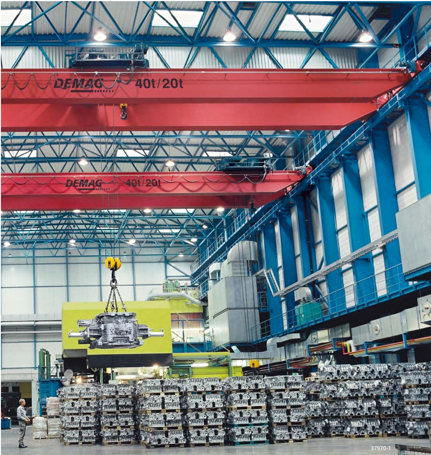
Zweiträger-Laufkran mit Tandem-Fahrwerken zum Transportieren und Wenden von Motorblöcken
