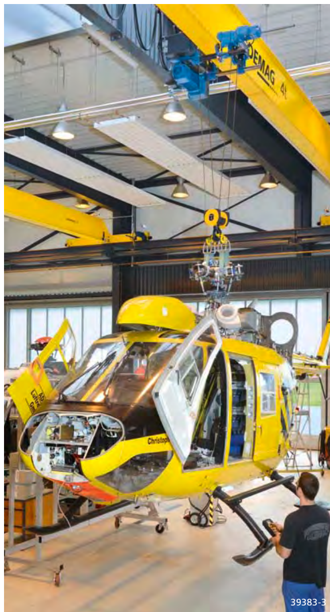
Demag Seilzüge bringen Helikopter für die Wartung in Position.
